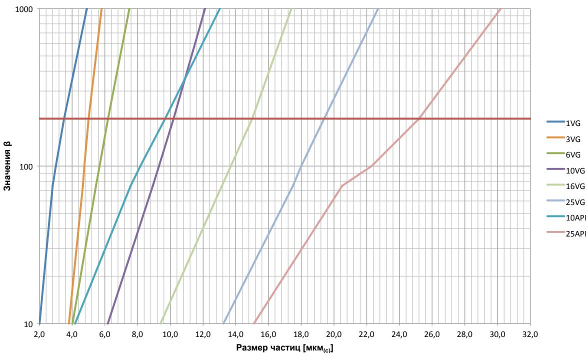
Характеристики при многократном пропускании жидкости в соответствии со стандартом ISO 16889
