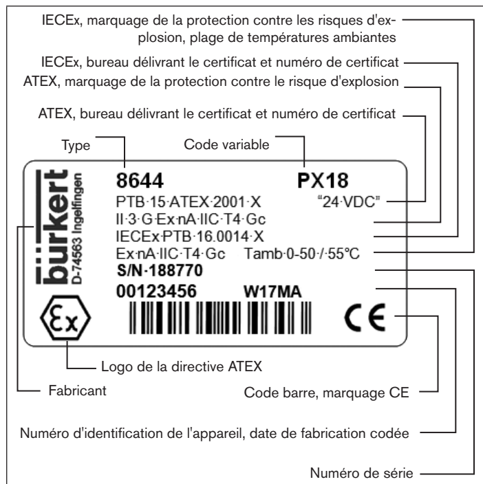
Fig. 1 : Description de la plaque signalétique de sécurité
