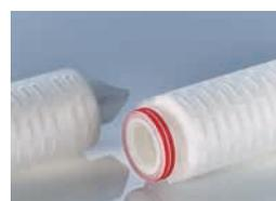
**Código 7:** Abierto por un lado (SOE), junta tórica 2-226 adaptador de bayoneta doble con punta de centrado, diámetro exterior 56 mm (punto más bajo)
