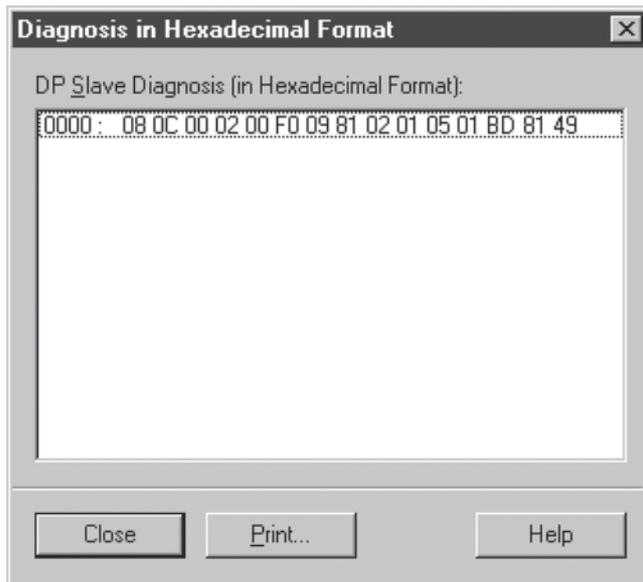
Bild: Peripheriefehler auf Modul 2 im Status-PDU Format
