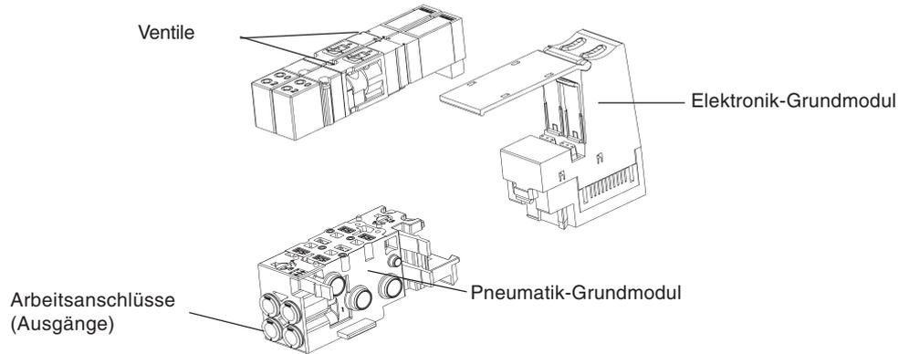
Modularer Aufbau der Ventilscheiben
