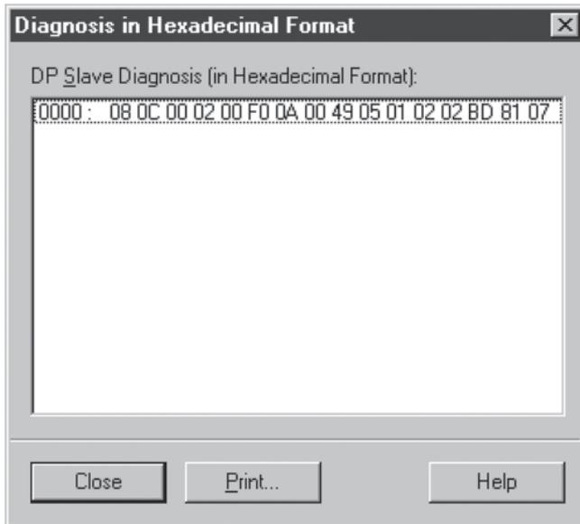
Bild: Peripheriefehler auf Modul 2 im herstellerspezifischen, vom DPV1 – Feldbusknoten bekannten Format
