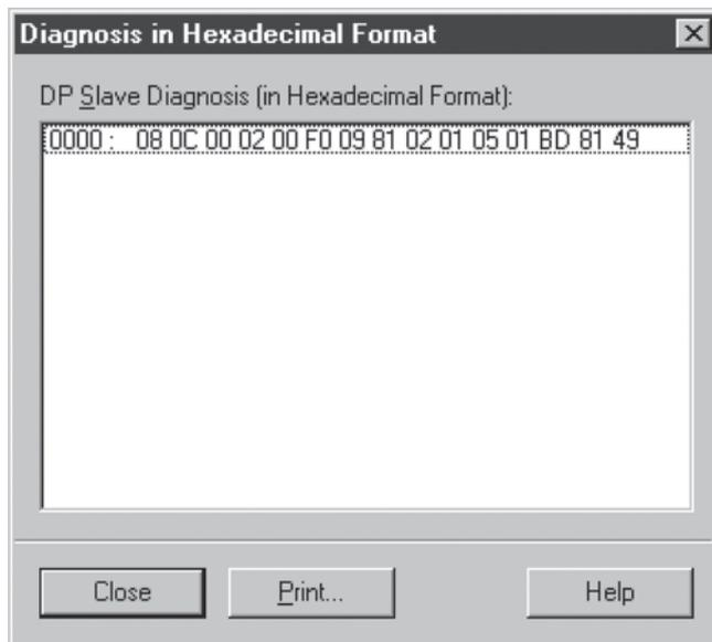
Bild: Peripheriefehler auf Modul 2 im kennungsbezogenen Diagnoseformat
