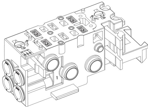
Beispiel eines Pneumatik-Grundmoduls
