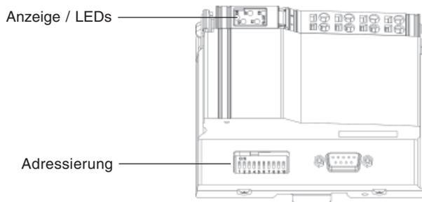
Mit dem 10fach-DIP-Schalter können Sie PROFIBUS-Adresse und Verhaltensweisen der PROFIBUS-Busklemme einstellen. Die Bedeutung der DIP-Schalter für die PROFIBUS-Busklemme ab Seriennummer 37344 entnehmen Sie der folgenden Tabelle.
