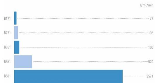
Bedingungen:  $\Delta p = 100 \text{ kPa}$  (1 bar), Medium: Wasser bei 20 °C
