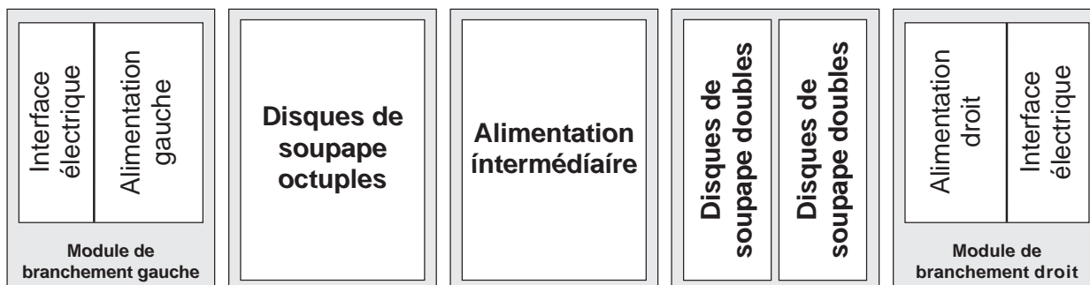
Exemple schématique d'un bloc pneumatique
