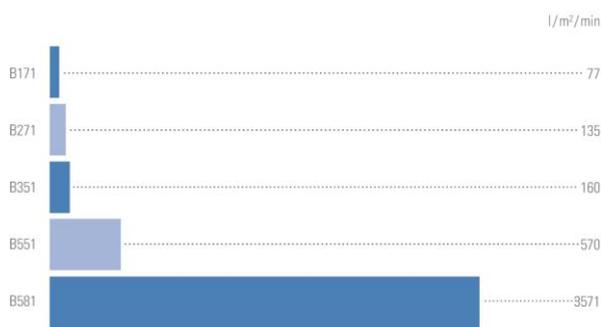
Conditions :  $\Delta p = 100$  kPa, sovlant : eau à 20 °C
