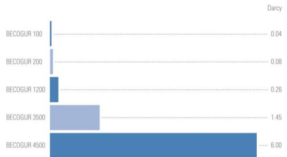
La perméabilité est mesurée en Darcy. Un Darcy a la valeur 1 ml/s. C'est le débit par un cube de plaques filtrantes en profondeur/adjuvants de filtration de la longueur de bord 1 cm pour une colonne de liquide de 1 m du liquide à filtrer.
