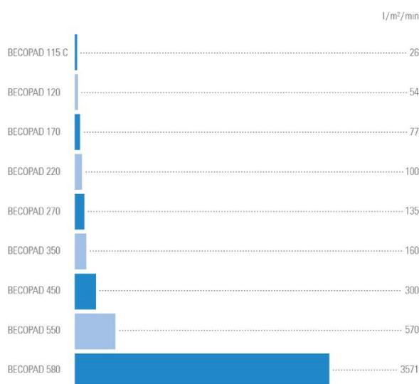
Bedingungen:  $\Delta p = 100 \text{ kPa (1 bar)}$ , Medium: Wasser bei  $20 \text{ }^\circ\text{C}$
