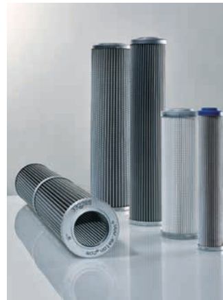
01.NL 在线滤芯 名义流量：40 – 1000 (30 bar 和高压差) 这些滤芯满足 DIN 24550-3 标准，是用于保护系统元件的压力过滤器的理想选择。
