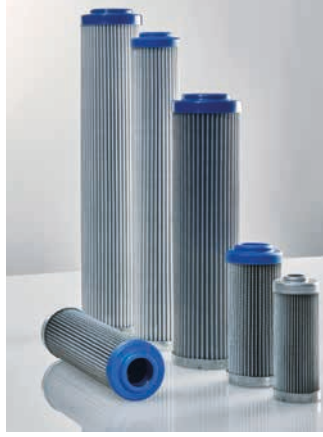
01.E 压力滤芯 名义流量：30 – 1350 (30 bar 和高抗爆压差) 这些滤芯非常适用于中压和高压在线过滤器，以保护液压阀和液压马达等系统组件。
