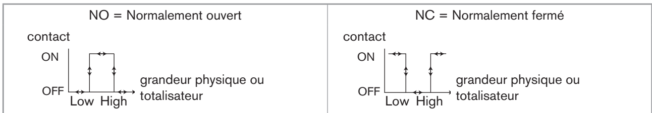
Fig. 40 : Fonctionnement en fenêtre
