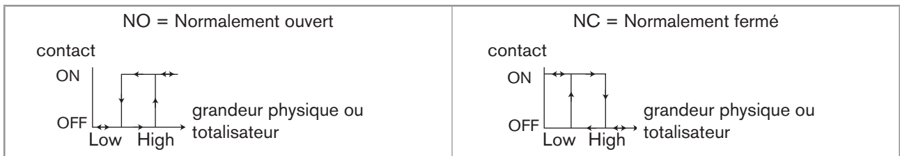
Fig. 39 : Fonctionnement en hystérésis
