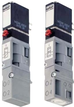
Die Ventile vom Typ 6526 und 6527 bestehen aus einem Vorsteuer-Wippenmagnetventil vom Typ 6106 und einem Pneumatiksitventil. Das Wirkprinzip erlaubt das Schalten hoher Drücke bei geringer Leistungsaufnahme und mit kurzen Schaltzeiten. Die Vorsteuerventile sind serienmäßig mit einer Handbetätigung ausgestattet.
