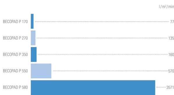
Conditions :  $\Delta p = 100 \text{ kPa}$ , sovlant : eau à  $20 \text{ }^\circ\text{C}$
