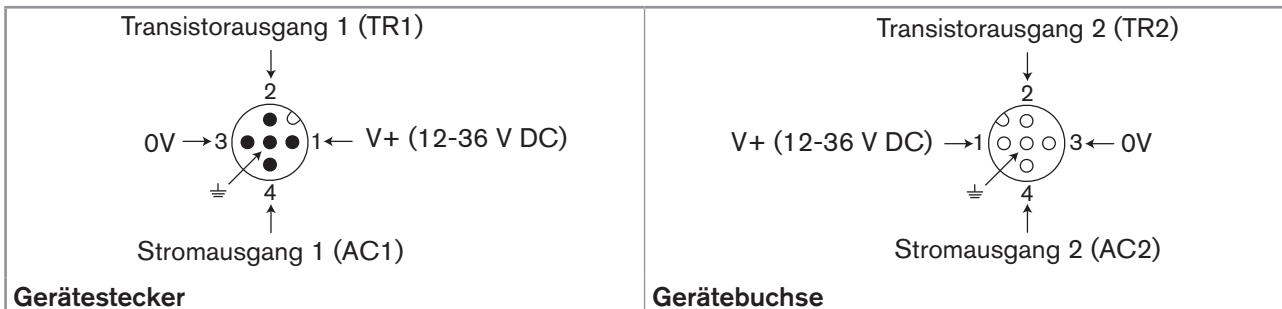
Bild 27 : Pin-Belegung des M12-Gerätesteckers und der M12-Gerätebuchse
